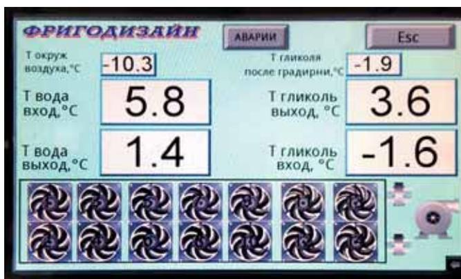
Температура «ледяной» воды на контроллере системы управления
