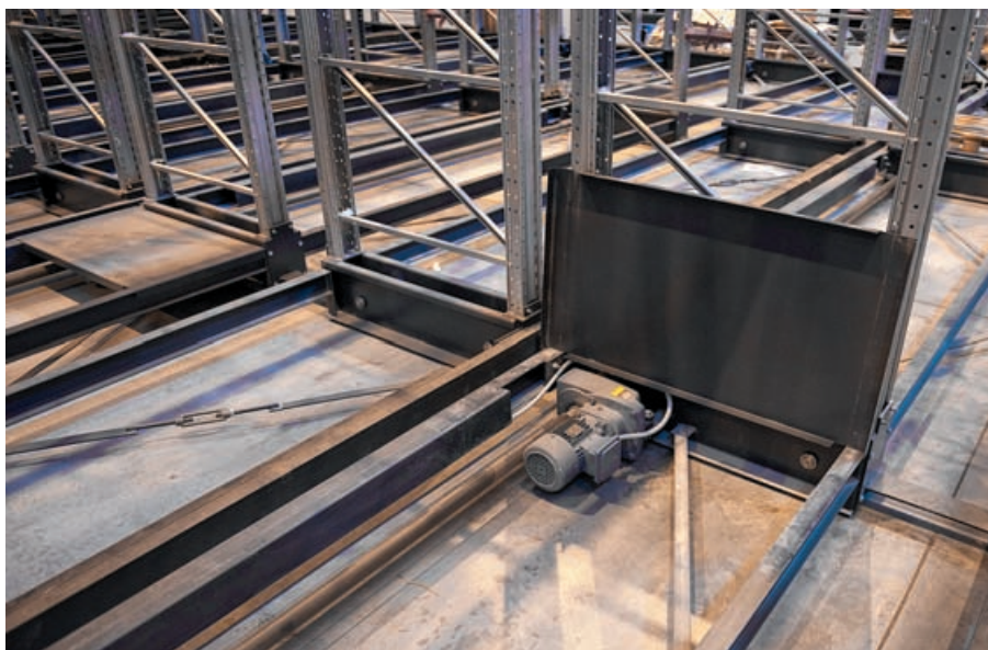
Рис 4. Секция мобильного основания с двигателем.
