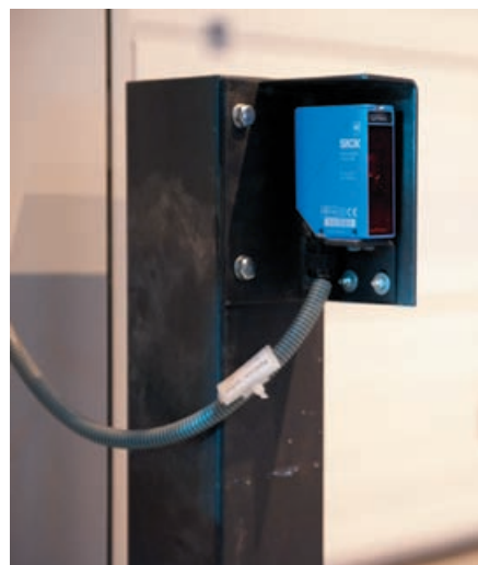
Рис. 6. Система безопасности: стойка с датчиком на фотоэлементах.
