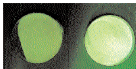
Рис. 2 — Состояние поверхности образцов мороженого с 100% заменой МЖ на ЗМЖ через 60 мин. выдерживания при температуре 20°C
