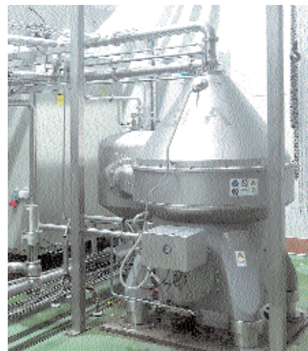
Сепаратор GEA для отделения дрожжевых клеток из кваса
