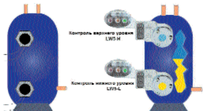
Рис. 2. Контроль и визуализация двух уровней жидкости
