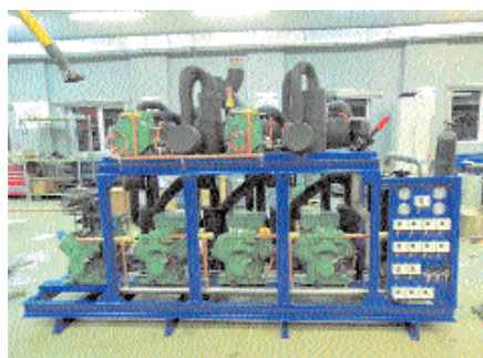
Компаундная установка на сборочном производстве в компании «Криофрост»
