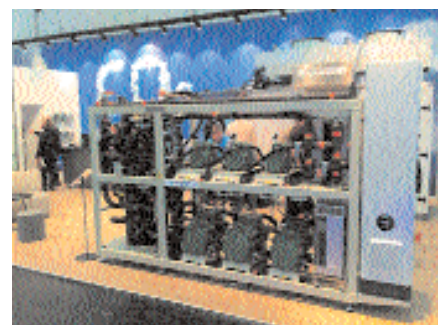
Транскритическая бустерная установка с параллельными компрессорами
