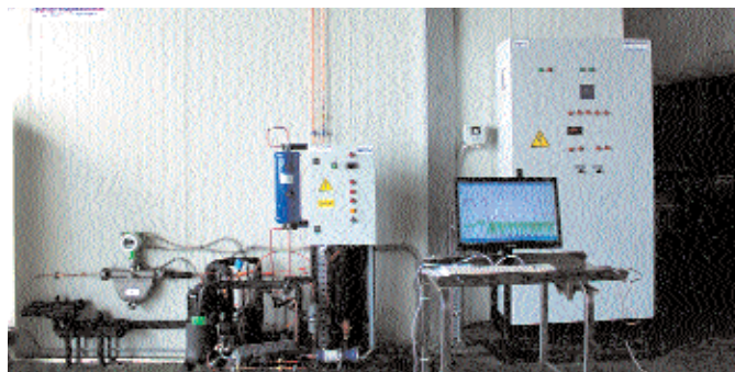
Рабочее место оператора при климатических испытаниях торгового холодильного оборудования CRYSPI
