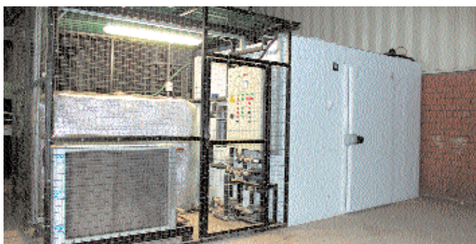
Низкотемпературная камера «Фригодизайн» с водяными ваннами для испытаний керамических блоков на морозостойкость
