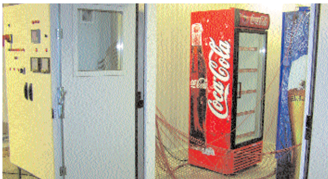
Холодильные шкафы-витрины загружены в камеру для климатических испытаний с имитацией температуры влажности и скорости окружающего воздуха
