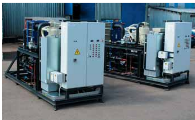
Генераторы ледяной воды (0,5...1,5°C) в проточном испарителе с частотным преобразователем привода компрессора J@E Hall холодопроизводительностью 600 кВт с расходом до 80 м 3 /ч каждый
