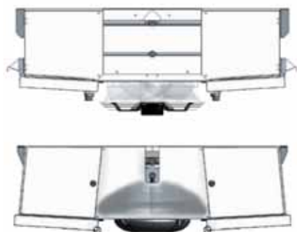
Рис.2. Традиционная конструкция двухпоточного воздухоохладителя (вверху) и новая конструкция DVR (внизу)
