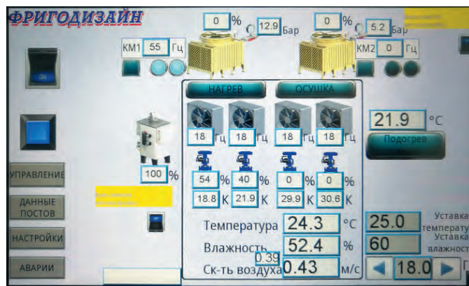
Визуализация работы оборудования климатической камеры на компьютере оператора
