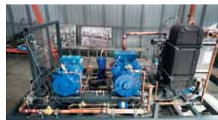
Двухкаскадный холодильный агрегат для АО «Рафарма»
