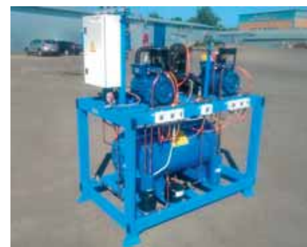
Двухкаскадная холодильная установка для камеры сублимационной сушки
