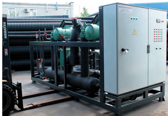
Отгрузка двухкомпрессорного агрегата установки холодоснабжения фризеров
