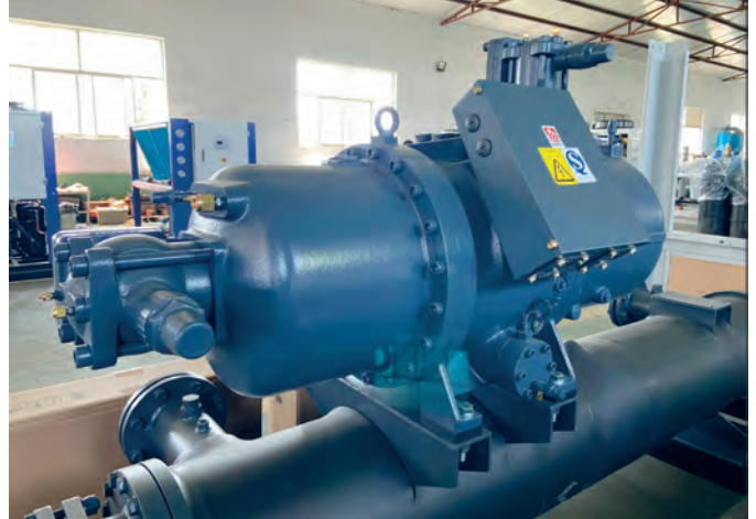
Рис. 5. Полугерметичный винтовой компрессор производства КНР
