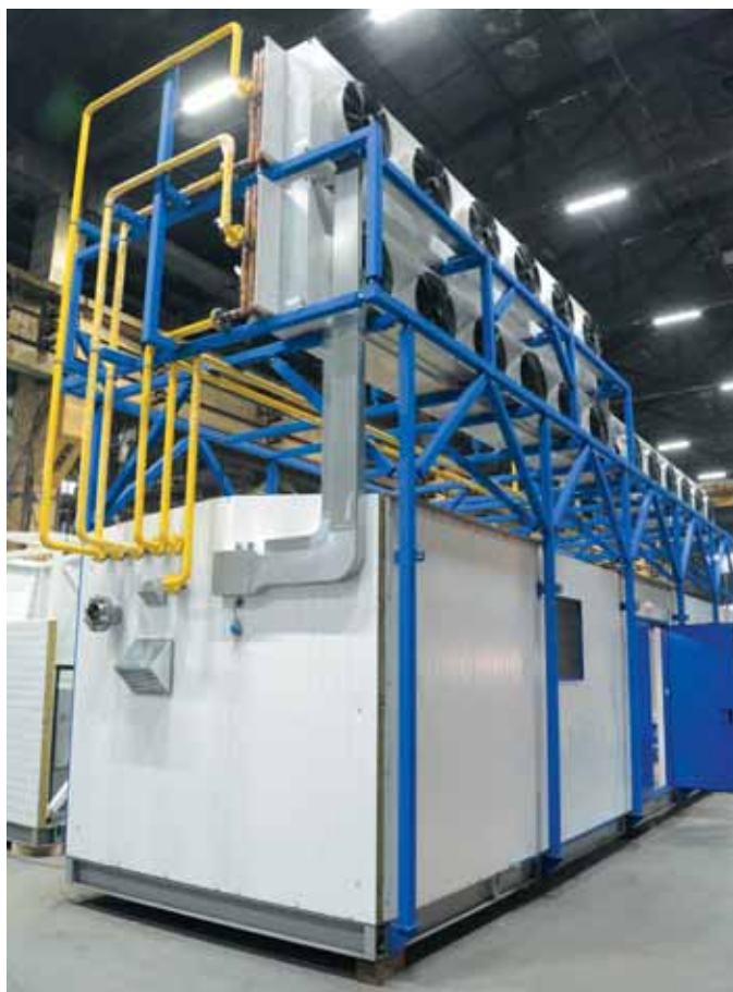
БХУ600-3В-2КВ-ЗИК-R507 ( Q_0=460 кВт, N_{\text{потреб}}=348 кВт) – 1 шт.
