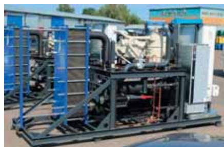
Установка ледяной воды
