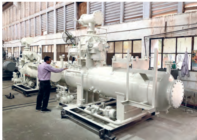
Рис. 4. Готовые к установке электродвигателей винтовые компрессорные агрегаты
