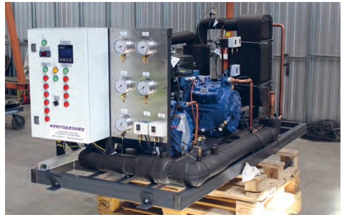
Двухкаскадный холодильный агрегат для сублимационной установки перед отгрузкой заказчику
