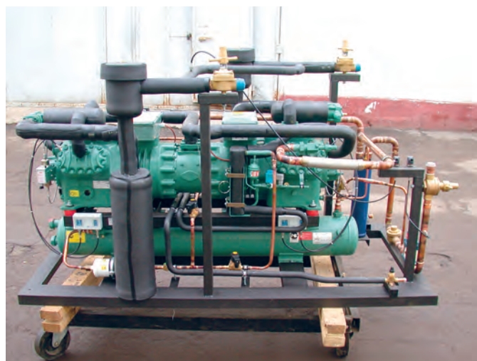
Холодильный агрегат для сублимационной установки
