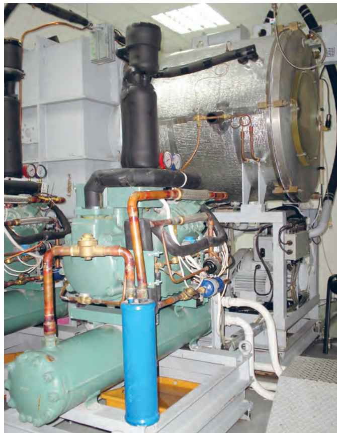
Сублимационная установка с холодильным агрегатом
