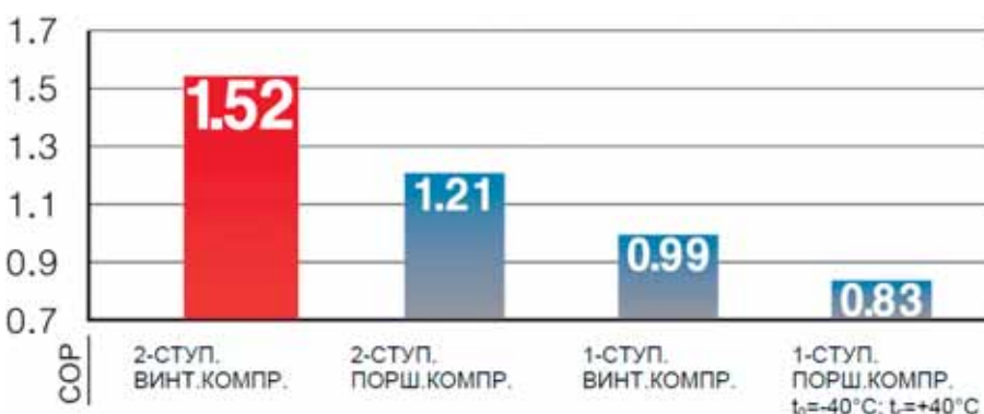
Сравнение холодильного коэффициента (C.O.P.) для различных компрессоров на R404A
