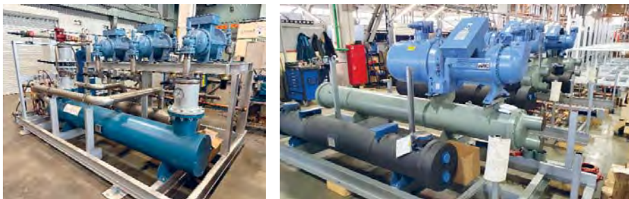
Кожухотрубные теплообменники REFKAR в готовой продукции «ТЕРМОКУЛ» и «РЕФКУЛ»
