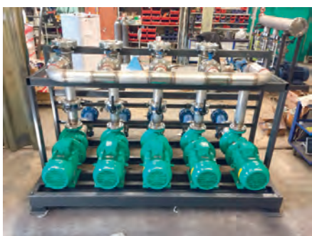
Рис. 4. Насосный агрегат с 5-ю насосами и объединенным коллектором нагнетания
