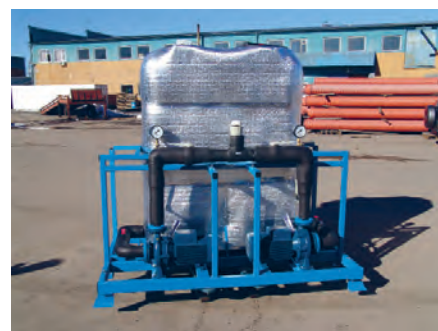
Рис. 5. Гидро модуль на 2-х насосах с аккумуляторным баком
