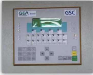
Замена панели управления на компрессорном агрегате GEA (Grasso)
